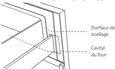
ou les surfaces d'étanchéité du tiroir, si le guide d'ondes est endommagé ou s'il y a des bosses à l'intérieur de la cavité ou à l'avant du four. Si vous découvrez des dommages, veuillez ne pas faire fonctionner le tiroir four à micro-ondes et communiquer avec votre détaillant ou un AGENT DE SERVICE SHARP AUTORISÉ.
