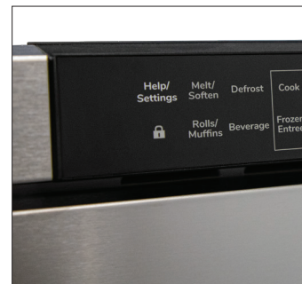
Activer le verrouillage des commandes pour éviter les manœuvres accidentelles
